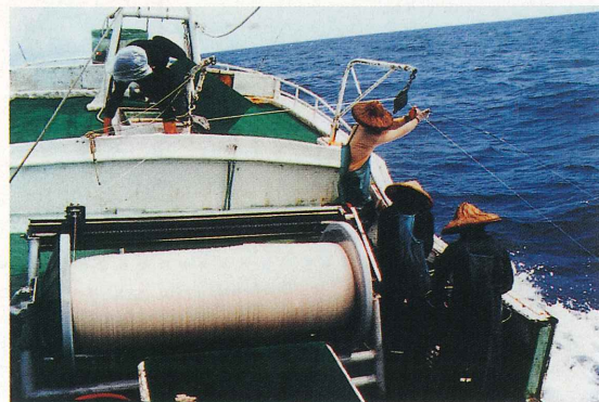
圖 5 美式小型鮪延繩釣自動化設備的揚繩作業。
