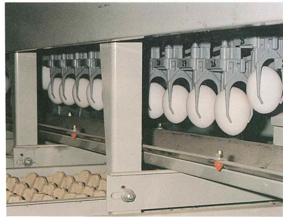
圖十一 計量機構與抓蛋及放蛋的情形
