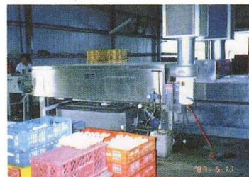
圖六 前檢視作業與 洗蛋機及烘乾裝置
