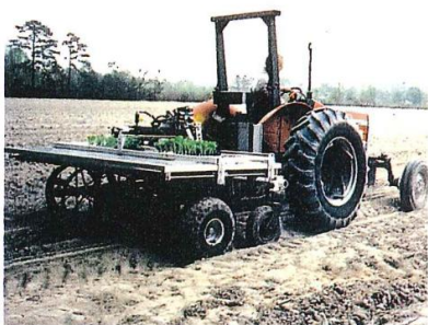
圖 10 (a) 和 (b) 所示為溫室用全自動移植機，(a) 為由穴盤移植於組鉢盤內，(b) 為由穴盤直接移植於單鉢內的情形。(c) 為本田用兩行式全自動移植機的作業情形。這些全自動移植機均用衝動式真空吸苗移植裝置，機構簡單而作用確實。
