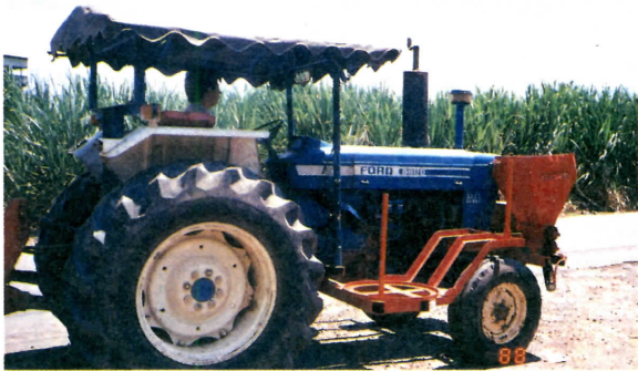
圖一 曳引機自載肥料簡易裝置全貌 引擎兩側各可裝載肥料 8 至 10 包
