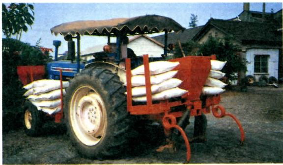
圖二 曳引機後面三點連接農具架上 也可承載肥料 4 至 8 包
