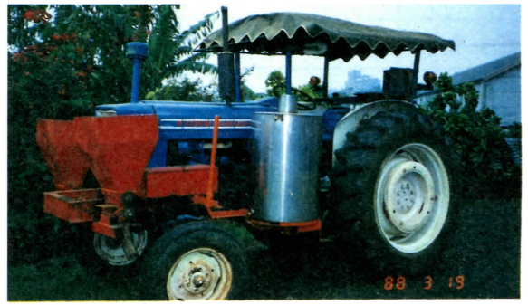
圖四 肥料架上也可承載葯液筒， 兼作噴洒農葯之用
