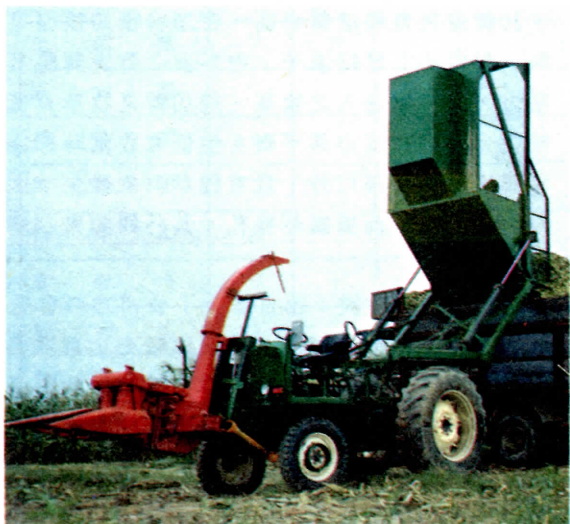
圖一 利用廢舊曳引機加以改裝之牧草收穫機
