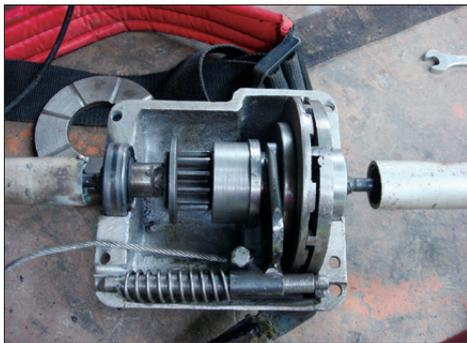
圖1 動力脫離裝置初型製作品
