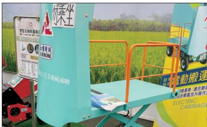
圖21 電動自走升降作業車
