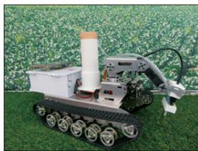
圖26 全地形履帶式田間機器人
