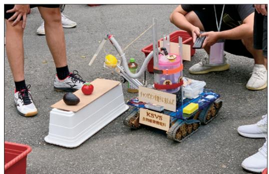
圖18 夾取正確顏色之水果模型
