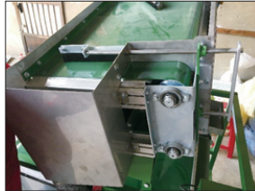
圖4 開口調整器可把關良品槽良率
