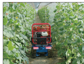
圖3 農業噴藥機器人在同一行間雙邊噴藥
