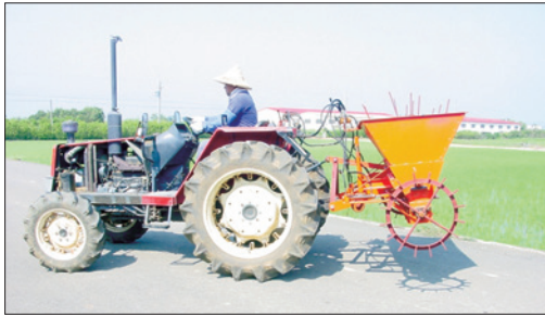
圖2 多用途施肥機與曳引機連接側視圖
