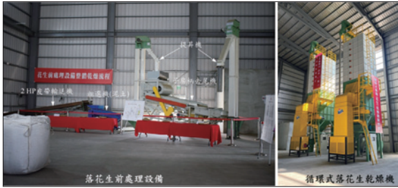
圖5 落花生乾燥前需使用前處理設備除雜，把泥土、砂石、枝條以及子房柄去除(圖左)。循環式落花生乾燥機(圖右)。
