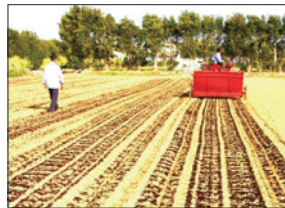
圖4 多用途施肥機田間施用有機質肥料情形
