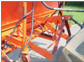
圖3 施肥機與曳引機三點連接示意圖
