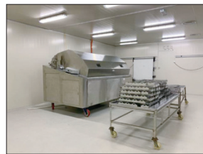
圖21, 圖22 真空乾燥設備與其果乾產品
