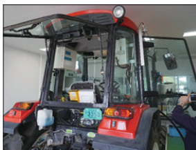
圖43 附掛監控設備及無人駕駛相關之控制設備
