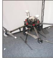
圖121 結合物聯網技術之旋翼飛行裝置
