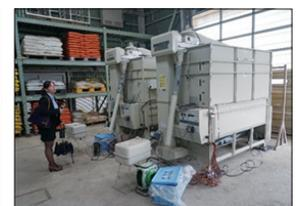
圖15 穀物乾燥機溫濕度多點量測
