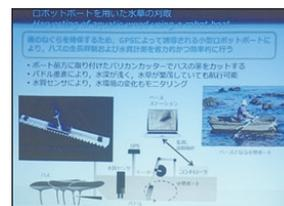
圖6 無線遙控船設計結構示意圖
