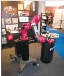
圖120 Sawyer 公司 展示之小型智能化機器手臂，影像定位辨識夾取散置目標物。
