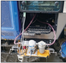
圖16 曳引機田間作業之耗油率量測機
