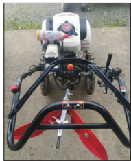
圖18 瓦斯燃料動力驅動之中耕機
