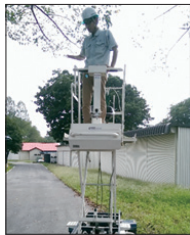
圖19 具自動調整水準之電動升降作業台車
