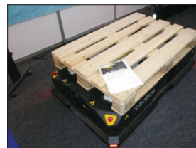
圖119 棧板自動搬運機器人循產線軌跡自動移動，低電量時即返回充電
