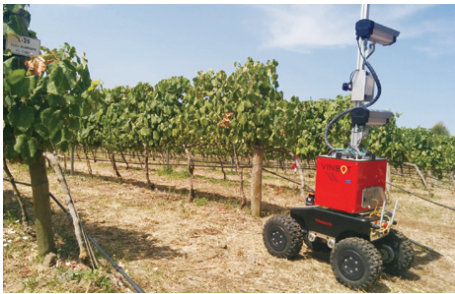
圖2 西班牙開發用於葡萄園的自走車型田間機器人
