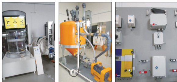
圖26 養豬畜牧場之進氣通風設備 圖27 可供濕式餵飼料之養豬飼料預拌及泵送料系統 圖28 養豬畜牧場使用之機電整合控制器以及驅動器
