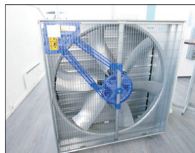
圖19 Munters 公司實體展示新款式變頻器搭配皮帶輪帶動馬達的通氣通風扇
