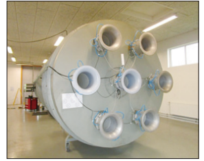
圖17 DACS通風實驗室之氣流量模擬系統
