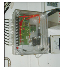
圖38 Veng System 以 CO 2 濃度作為控制畜舍大氣環境並因而研製出的感測器
