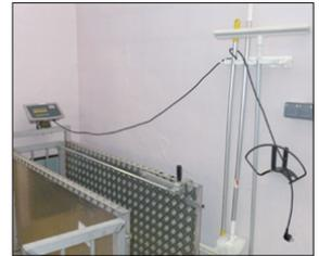
圖95 ToxAlim實驗豬舍的秤重儀器
