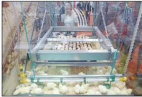
圖27 Vencomatic Group之智能化孵化自動輸送設備，小雞從第18天到21天孵化之後破殼，就從上方蛋盤跳出到小雞盛裝盤的墊料上，由系統輸送到各成長雞舍以熟悉環境
