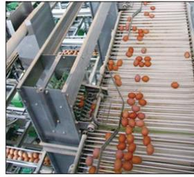
圖31 Zucami公司的自動化產蛋分級系統
