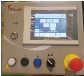
圖30 智能化蛋品孵化輸送設備的觸控式操作單元
