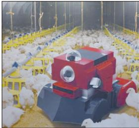
圖22 Octopus公司展示的自走式生物製劑噴灑機器人在於禽舍內使用情形
