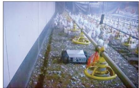
圖25 Tibot 公司的3軸向自主移動機器人可驅使產蛋雞運動，也促使在正確位置產蛋
