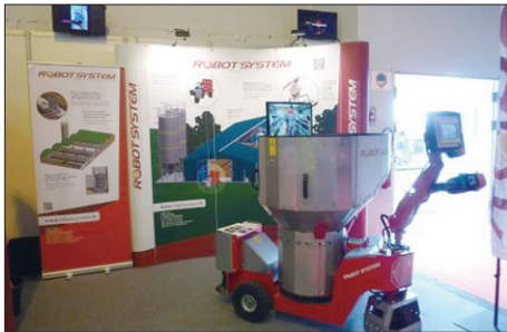
圖9 ROBOT SYSTEM公司之使用於家畜舍的智能自走式餵料機
