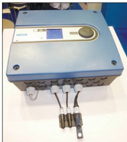
圖4 SKOV 公司研發之模組化智能通風環控器
