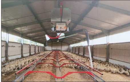
圖8 ROBOT SYSTEM公司之智能化鴨舍的飼料供應及墊料鋪設
