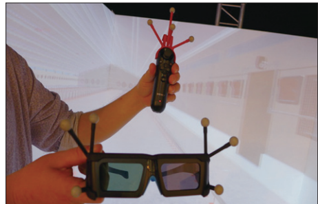
圖11 配戴SODALEC公司3D眼鏡可觀測禽舍之內部設計細節，並搭配遙控器可以縮放設計細部及移動影像觀測各部構造
