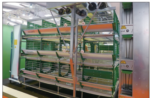
圖2 模組化之蛋雞飼養及自動化收集系統
