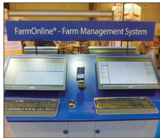
圖5 SKOV 公司所研發之禽畜舍智能化遠端監控系統以及以智慧手機進行監測管理
