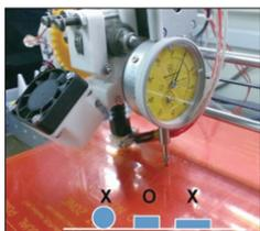
圖7 千分錶校準3D列印層高度
