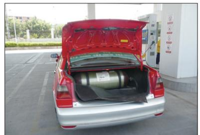
圖18 汽車後行李箱內之生質甲烷壓縮儲氣瓶外觀
