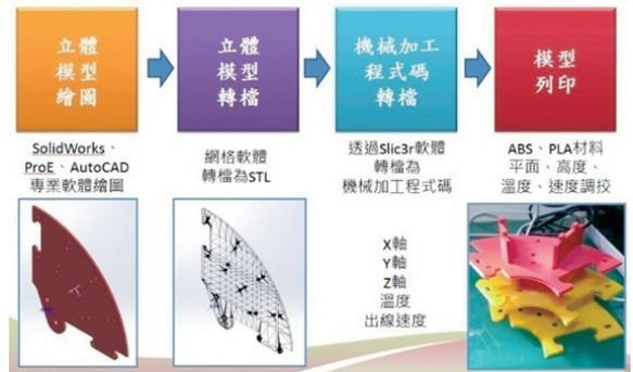
圖3 3D列印機立體模型製造流程
