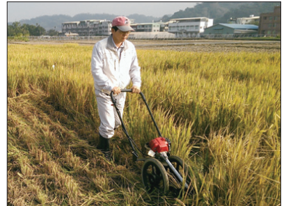
圖4 手推剪切式割草機於農業試驗所水稻田進行割草效能試驗，評估應用於再生稻之割草作業情況
