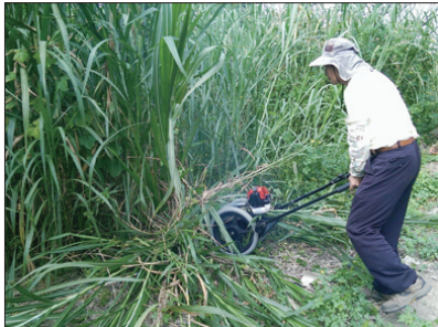
圖2 手推剪切式割草機進行狼尾草剪切試驗，測試刀具之耐受程度
