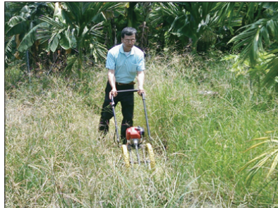
圖3 手推剪切式割草機於佈滿牛筋草之香蕉園進行割草試驗
