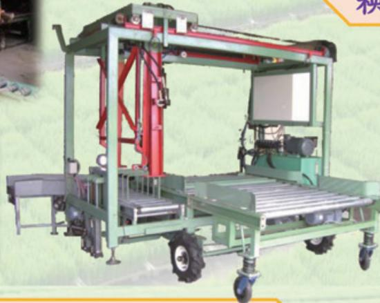
**自動取箱機**由棧板輸送單元、苗箱夾送單元及苗箱排放單元等所組成可堆疊四疊苗。苗箱排放單元以三箱或六箱為一疊依序排放至輸送帶上。三箱排放模式每小時取箱速度可達1800箱。六箱排放模式每小時取箱速度可達2400箱。
