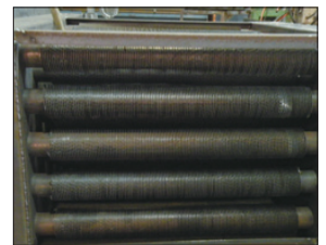
圖14 改良熱交換器附加鱗片
