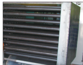
圖13 傳統乾燥機之熱交換器
