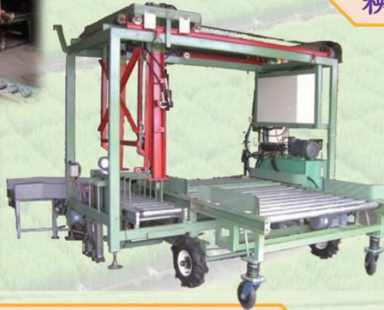
**自動取箱機**由棧板輸送單元、苗箱夾送單元及苗箱排放單元等所組成可堆疊四疊苗。苗箱排放單元以三箱或六箱為一疊依序排放至輸送帶上。三箱排放模式每小時取箱速度可達1800箱。六箱排放模式每小時取箱速度可達2400箱。
