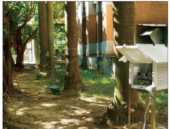
圖7 多功能型田間閘道器於臺大生機系知武館旁進行戶外實際長期佈建測試情況
