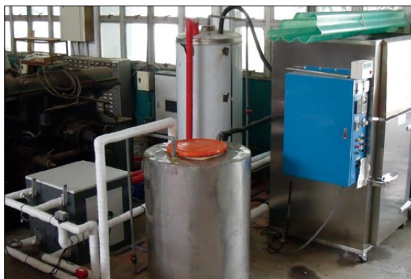
圖1 熱泵乾燥機主機(左)、熱水槽(中後)、冰水槽(中前)及冷凝乾燥箱(右)
