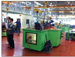
圖13 動力傳遞系統專用之滲漏測試裝置
