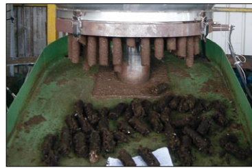
圖13 太空包廢棄木屑擠壓條製為衍生燃料
