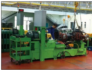
圖14 動力傳遞系統專用之耐久試驗平台
