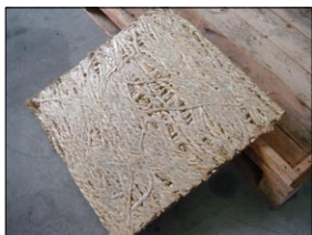
圖11 以草繩混合黏著劑壓製成板材
