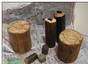
圖12 以稻稈或其他材料經壓製成型之固態錠型燃料
