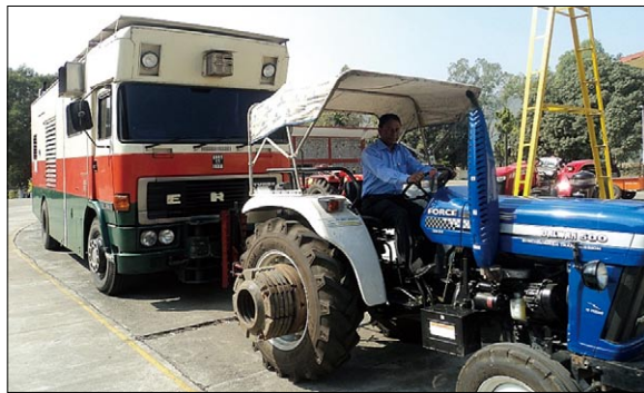
圖19 曳引機拖桿馬力試驗
