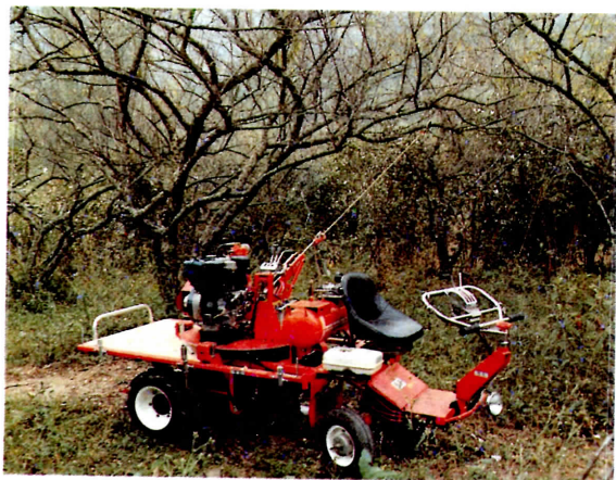
圖一 轉盤定向索引式振動採收機
