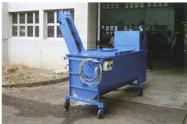
圖 6 蒸汽處理介質攪拌槽
