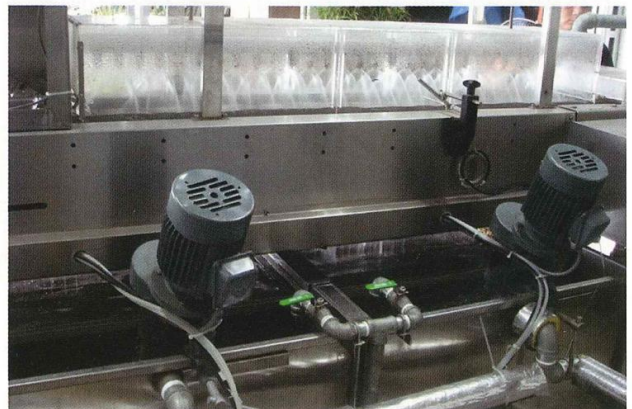
恆溫桶、溫度感測、攪拌裝置
