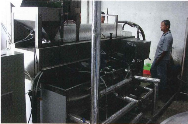
水稻連續式種子溫湯消毒機結構
