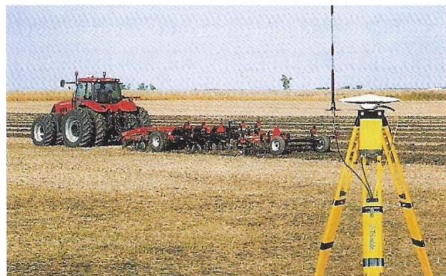
圖 4 現今 RTK 導航系統的準確度可達 1 至 2cm，而移動式 RTK 設備總有 5 至 20cm 的準確度，未來將可更準確。
