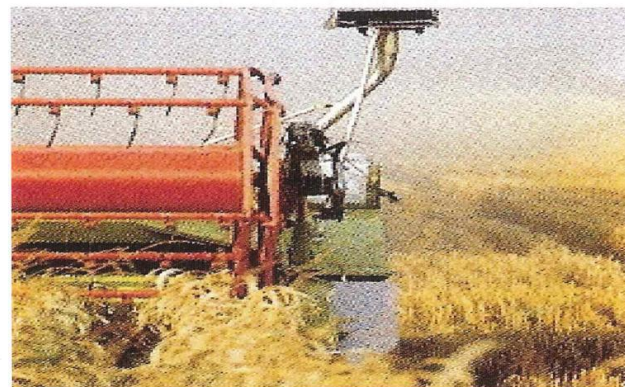
圖 6 Claas 公司的 Laser Pilot 能夠自動地操縱穀物聯合收穫機沿著種植作物的邊緣行駛。
