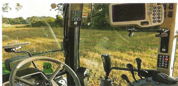
圖 1 John Deere 曳引機駕駛艙內裝設一種稱為 Greenstar 的監控器：在頂級配備中，具有連接部分寬度之電路與符合 ISO-Bus 標準之機械控制裝置的手動或自動轉向輔助納入車用電腦管理。
