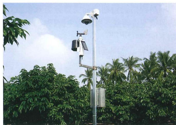
圖 3 氣象資訊監測站與球型旋轉攝影機 (Microclimatic monitoring system for litchee farm)
