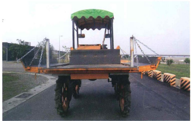
圖 3 高架式鳳梨搬運機 (High clearance vehicle for pineapple field)
