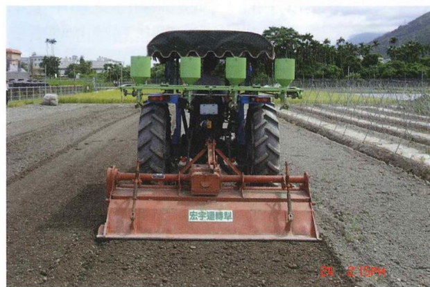
圖 2 油壓式傳動田間作業情形
