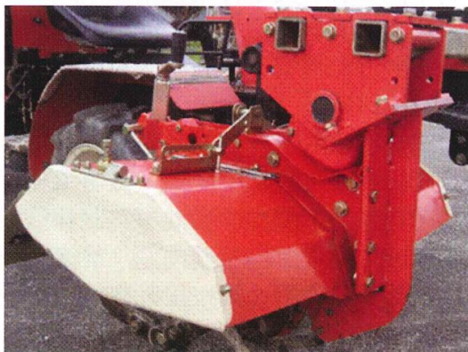
圖 3 果園側移中耕管理機之中耕機構及裝配掘刀
