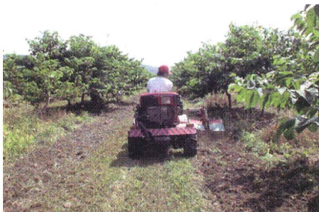
圖 5 果園側移中耕管理機伸入果樹冠下作業情形
