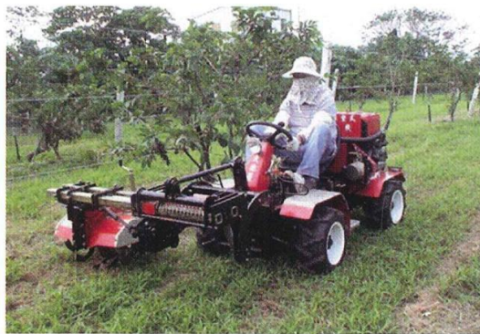
圖 1 果園側移中耕管理機之構造 (Right-hand offset cultivator)
