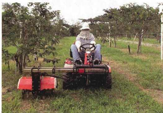
圖 2 果園側移中耕管理機中耕部水平方向移動至果樹冠下
