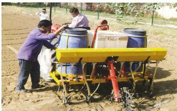
圖 3 印度農業試驗所農業工程組曳引機附掛式播種及 施肥一貫化作業機具田間操作示範情形
