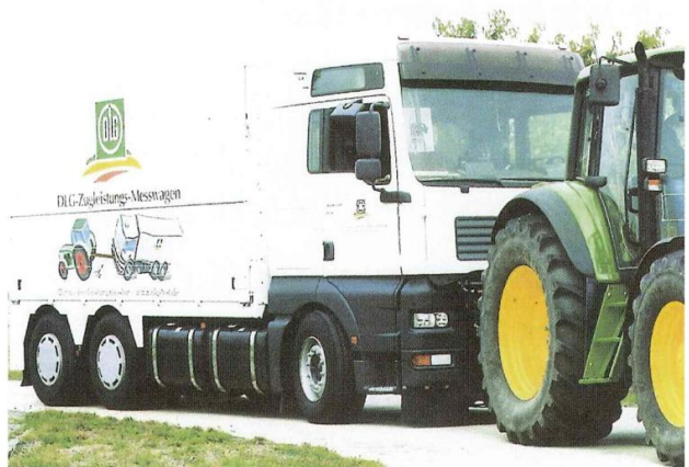
圖 5 新型曳引機拖桿馬力測試車 (圖片來源：profi 雜誌 2003/12)
