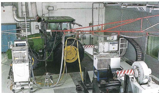
圖 9 曳引機 PTO 與耗油率測試 (圖片來源：profi 雜誌 2009/02)
