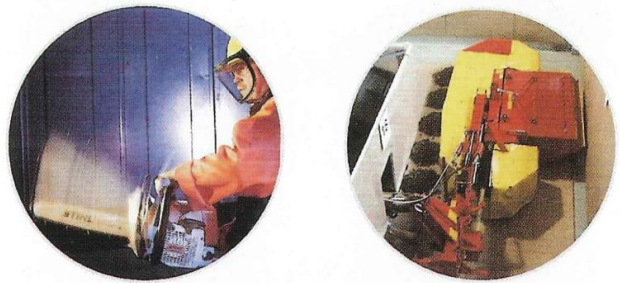
圖 3 鏈鋸安全測試(左)與割草機撞擊石塊測試(右) (圖片來源：DLG Test Centre 簡冊)
