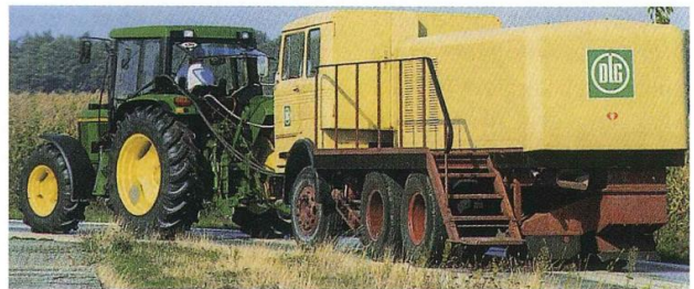
圖 4 2002 年前使用之曳引機拖桿馬力測試車 (圖片來源：profi 雜誌 2007/11)
