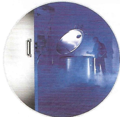
圖 13 可產生熱應力與冷應力的氣候室 (圖片來源：DLG Test Centre 簡冊)
