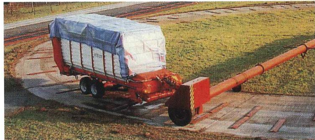
圖 12 執行長時間長距離農機應力測試的圓形跑道 (圖片來源：Ackerschlepper in der Pruefung 專刊)
