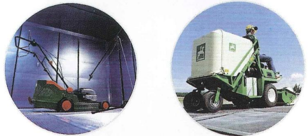
圖 11 農機噪音測試：(左)室內聲音量測間與(右)戶外開敞空間量測站(圖片來源：DLG Test Centre 簡冊)
