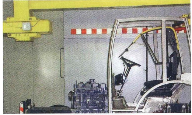
圖 10 曳引機 ROPS 測試 (圖片來源：profi 雜誌 2007/10)
