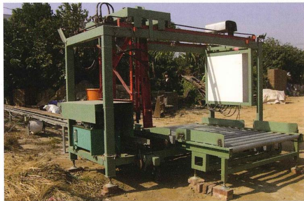
圖 3 秧苗箱自動取箱搬運系統
