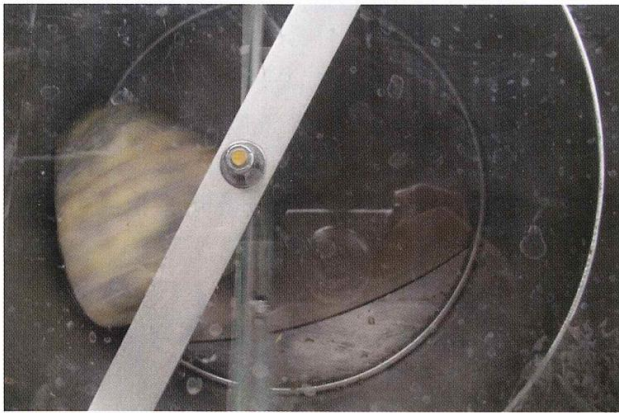
圖 4 果實在圓桶中產生連續性快速翻滾切削
