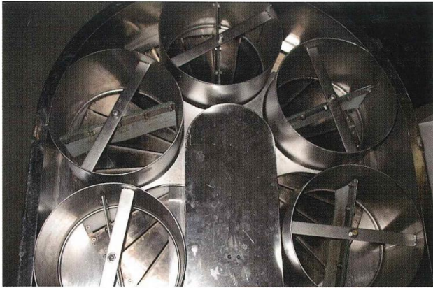
圖 3 去皮機之進料圓桶及削皮刀盤的構造
