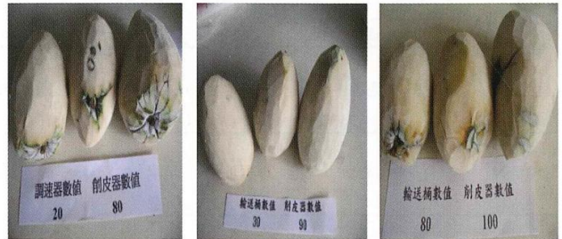
圖 8 未泡水冷凍果實使用不同進料圓桶速率及削皮刀盤轉數削皮後的情形
