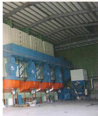
V model: 6~12tons CL 423V120型 容量CAPACITY: 12噸 高度HEIGHT: 8165mm
