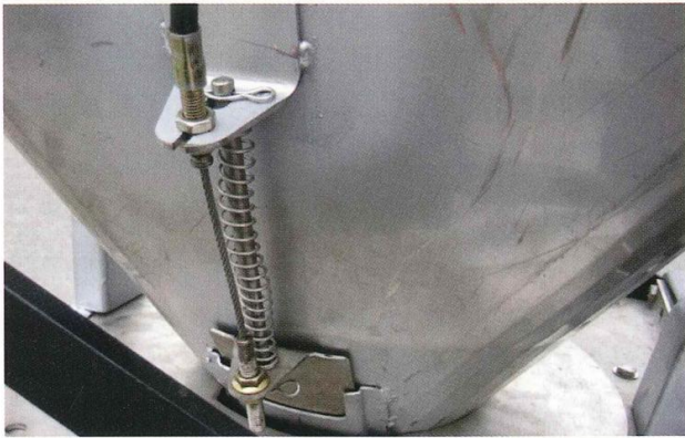
圖六 施肥箱肥料出口大小由螺絲、伸縮彈簧及鋼索組合而成
