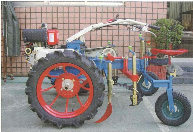
圖七 自走式洋蔥挖掘機側視圖
