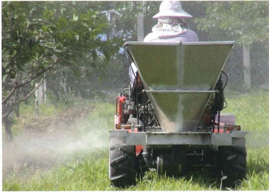
圖五 肥料出口設計有一可調整角度活動蓋板，控制肥料落下位置
