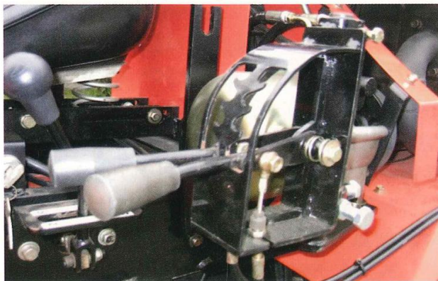
圖七 控制施肥箱肥料出口大小之左右拉桿
