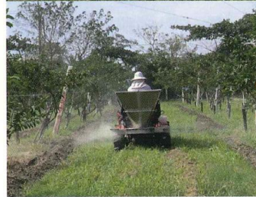
圖十一 承載式施肥機果園撒佈肥料至果樹冠下情形
