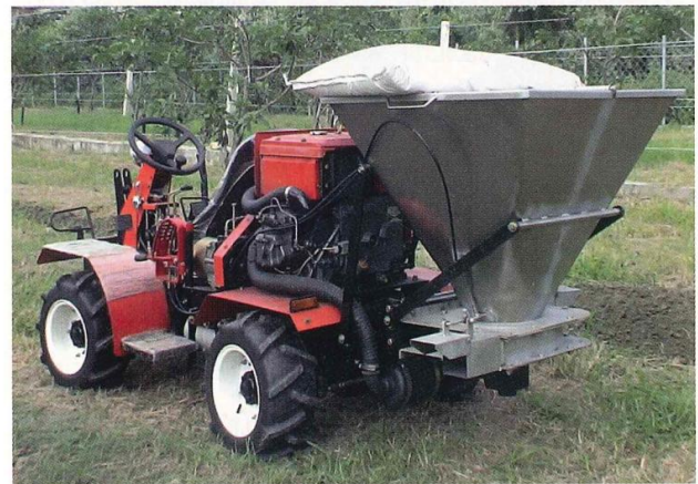
圖二 拆卸下割草機割草部成為承載式施肥機
