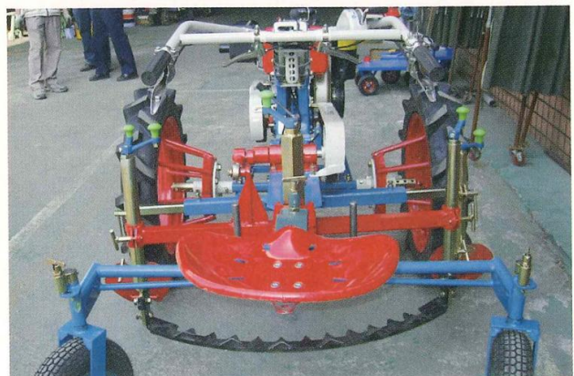
圖六 自走式洋蔥挖掘機正視圖
