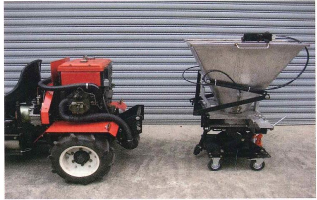
圖九 完成本機與施肥機總成拆卸分離動作
