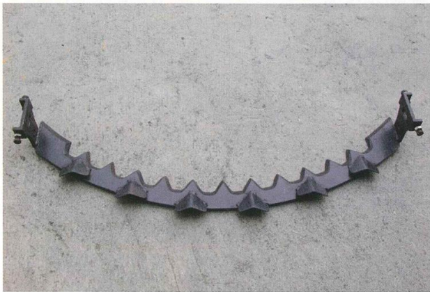
圖八 鋸齒形挖掘刀外觀
