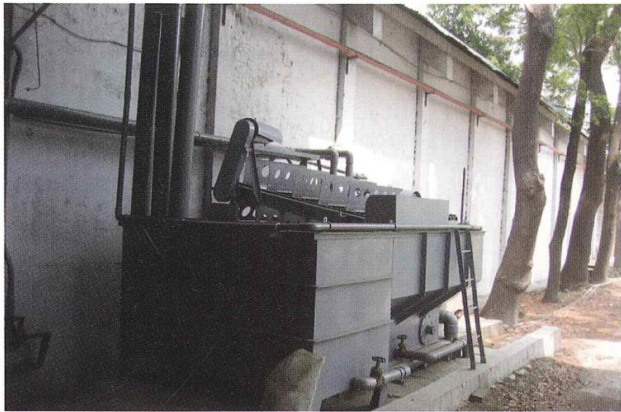
彰化縣農會田中倉庫乾燥中心污染防治濕式粉塵處理之污泥處理機
