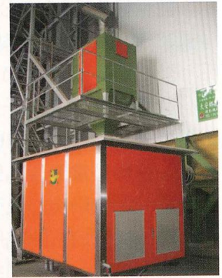
台中縣大安鄉農會低溫暫存冷凍機組(下側)及計量機(上側)
