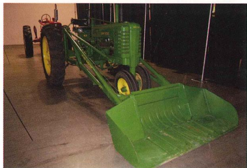
圖十八 1952 年 John Deere 公司生產裝有鏟斗的 B/W45 型曳引機，它的前輪有特殊設計的 Roll-O-Matic 懸掛系統，以減少曳引機在田間不平地面的跳動。John Deere 公司在 1935 年至 1952 年生產了近 30 萬部的 B 型曳引機。
