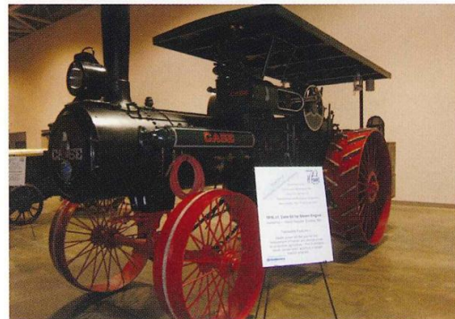
圖二 1916 年 CASE 公司生產的 65 馬力蒸氣引擎曳引機，19 世紀末期與 20 世紀初期蒸氣引擎曳引機開始取代田間之人力或畜力作業方式。
