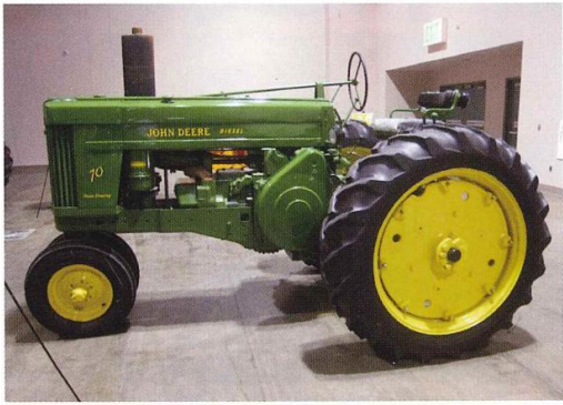
圖十九 1954 年 John Deere 公司生產第一部具有動力方向盤的 Model 70 曳引機。
