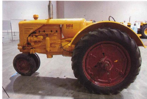
圖十六 1941 年 Minneapolis-Moline 公司生產的第一部以液態天然氣為動力源的曳引機。該曳引機也是第一部通過內布拉斯加性能測試的液態天然氣曳引機。
