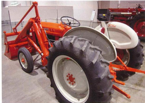
圖二十 1959 福特生產的第一部動力雙變速傳動裝置 (powershift) 曳引機，該機型有十個前進檔，兩個後退檔與停止檔。
