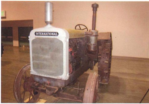
圖十一 1935 年 IH 公司生產的 McCormick-Deering WD-40 型曳引機為全世界第一部柴油引擎曳引機，在 1935 年至 1940 年期間約生產了 10,000 部該型曳引機。
