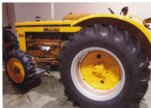
圖廿一 Minneapolis-Moline 公司於 1962 年生產的 G-704 曳引機，PTO 為 102 馬力，為第一部於工廠安裝前輪輔助系統(Front-Wheel Assist)之曳引機。
