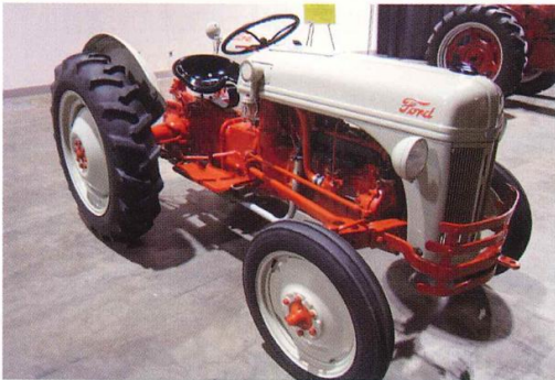
圖十三 1939 至 1941 年期間福特生產的 9N 型曳引機為第一部配備三點鏈接的泛用型曳引機，照片中為同一系列改良之 8N 型曳引機，1939 至 1952 福特公司一共製造了 827,000 部該系列之曳引機。
