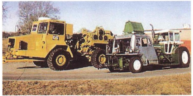
圖二 NTTL 目前以及先前使用的負載車輛，圖右的配置源自 1963 年，但灰色的艙室係 1937 年負載車的一部分。
