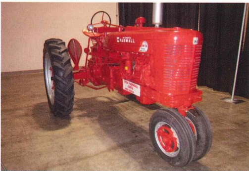
圖十四 IH 公司生產的 Farmall 牌曳引機為泛用型且適用於行列作物的曳引機，在 1939 年至 1952 年生產了超過 39 萬部，為當時北美洲銷售數量最高的曳引機。照片中為 1954 年生產的 Super M-TA 型曳引機，它的 Torque Amplifier (TA) 設計允許該機可以迅速換檔依作業需求降低行進速度以提升拖曳力。
