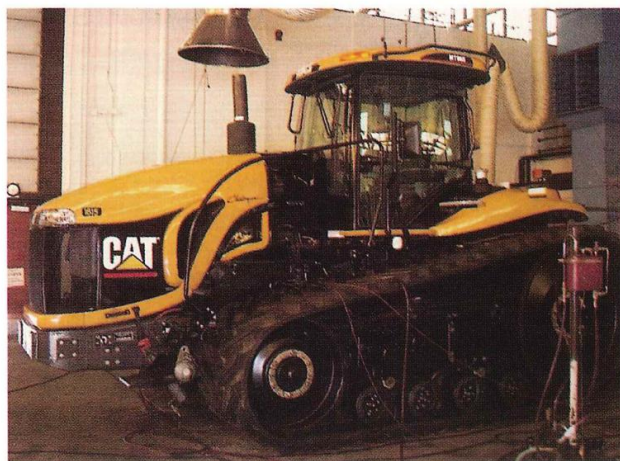
圖一 正在進行 PTO 測試的曳引機
