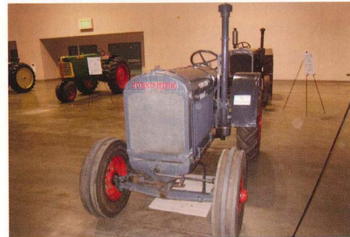
圖八 1929 年 McCormick-Deering 公司生產的 10-20 型曳引機使用煤油為燃料，此機型為該公司 8-16 型的延伸機型，於 1929 年至 1939 年期間生產，後續又發展出 15-30 機型。
