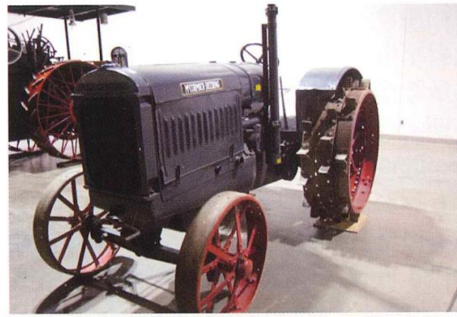
圖七 1926 年由 McCormick-Deering 公司生產的 15-30 型曳引機，以配置 PTO 為賣點，其多用途的動力輸出配置，取代了更多的田間勞力，也開啟了後續大馬力曳引機的設計與製造風潮。
