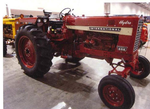
圖廿二 1969 年 International 公司推出第一部液壓傳動的曳引機 656 Hydrostatic，該機型雖然在當時沒有佔據廣大市場，但是液壓傳動後來逐漸成為曳引機常用的傳動方式。
