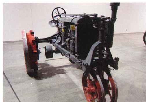
圖六 1924 年生產的 Farmall IH 具有間距小的前輪與離地 30 英寸高的後輪軸，該設計使得該型曳引機成為第一部使用於行列作物的曳引機。
