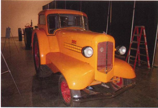
圖十二 1938 年 Minneapolis-Moline 公司生產了少量的「舒適曳引機(Comfort Tractor)」，採用橡膠輪胎，可以在田間作業，也可以快速行駛於道路，時速達 40 英里，可乘坐兩人，配備收音機與暖氣，在曳引機的設計上已經加入了舒適度的考量。
