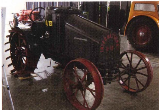
圖四 1918 年由 International Harvester Company (IHC) 所生產的 International 8-16 型曳引機為第一部提供動力輸出裝置 PTO 之曳引機。
