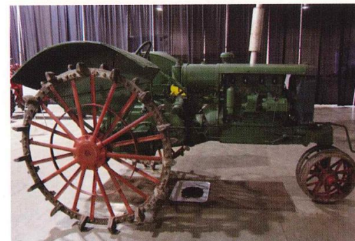
圖九 1930 年由四家公司合併組成的 Oliver 公司為當時美國最大的農業機械製造廠商，照片中為該公司生產之 Oliver 18-27 型曳引機，為第一部可調整後輪間距（60 至 74 英寸）之曳引機。當時該機型之售價為美金 985 元。
