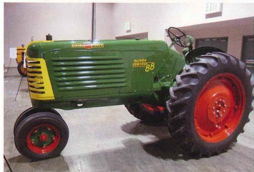
圖十七 1949 年由 Oliver 公司生產的 88 型曳引機，其特色為柴油六缸引擎，直接電力啟動柴油引擎。在 1954 年的售價為 3,000 美元。
