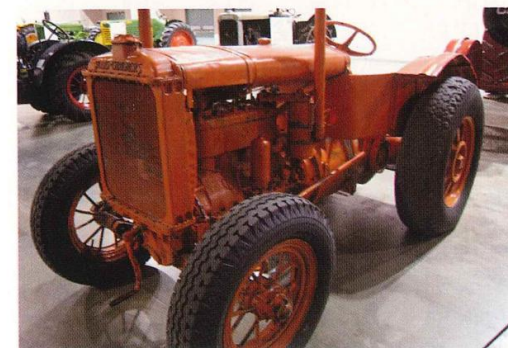
圖十 1932 年 Allis-Chalmers 公司生產的 U 型曳引機，該機型為第一部使用充氣橡膠輪胎之曳引機，當年之售價約為美金 1050 元，在 1929 年至 1952 年期間，該型曳引機約銷售了 20,000 部。
