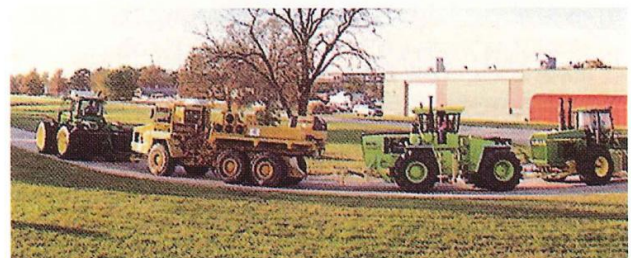
圖四 正在進行拖桿測試的四輪驅動式曳引機，兩台附掛在負載車後方的曳引機提供額外的配重來增加負載，背後的建築物即為 NTTL 現址。
