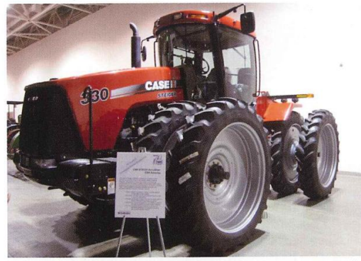
圖廿三 Case IH 公司生產的 Steiger AccuSteer 型曳引機為現代曳引機的典型，具有馬力大、多功能、操作舒適、自動感測與控制等特性，比較傳統曳引機，該機型已經跳脫後輪大前輪小的設計概念。
