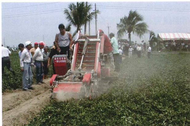
圖七 自走式甘藷一貫化收穫機田間收穫示範
