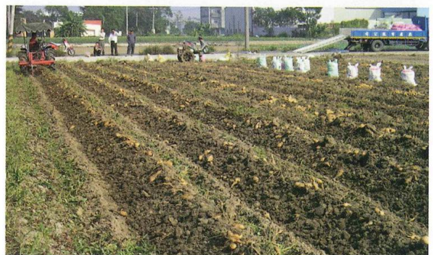
圖二 曳引機附掛式甘藷挖掘犁(左上)作業情形(圖中中上亦顯示甘藷藤蔓割除專用機)
