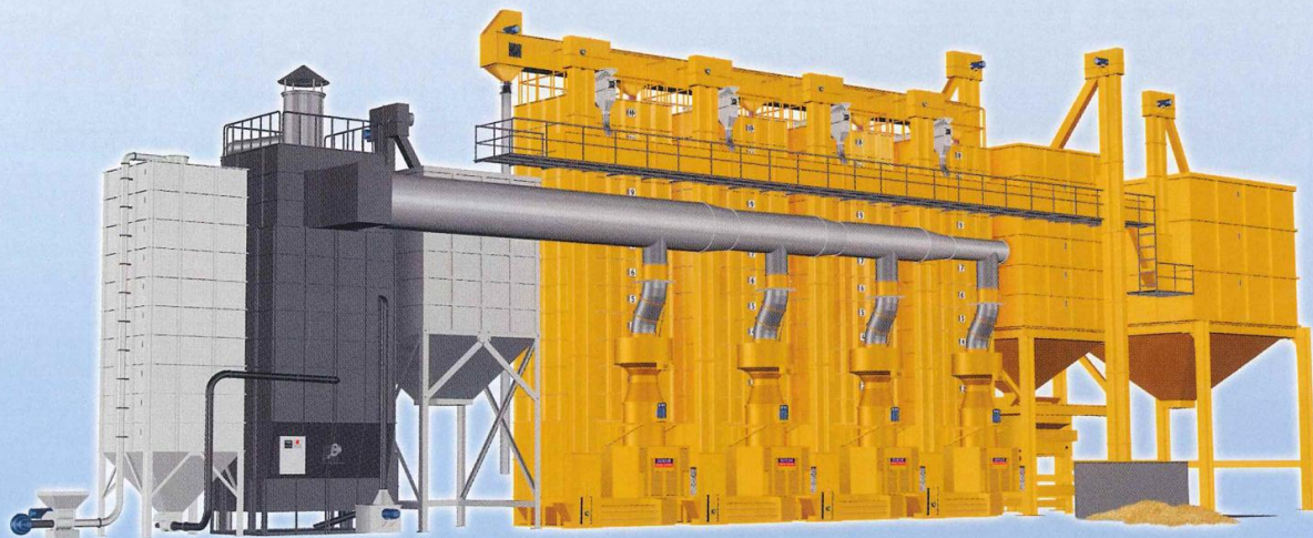
HB-120 粗糠爐：可燃粗糠、玉米穗軸
