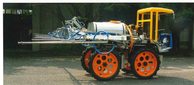
圖三 高低莖作物施藥機懸垂噴桿翻轉 90 度之情形
