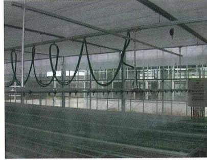
圖二十 華南牌 W-BOOM 型自走式自動噴灌裝置
