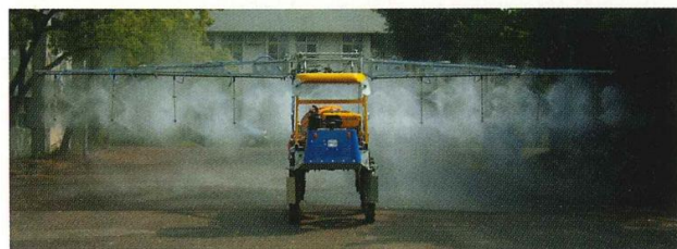
圖二 高低莖作物施藥機(專利申請中)裝設懸垂噴桿施噴之情形
