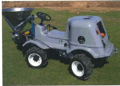
圖十九 永三源牌 YSY320 型乘坐式動力施肥機
