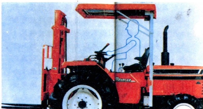
圖 1B 反置式曳引機向後行駛
