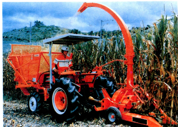
圖3 反置式曳引機附掛青貯玉米收穫機及小型貨架
