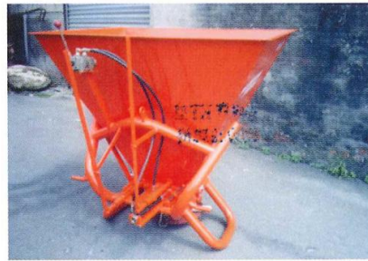
青擘牌油壓型(錐形體)動力施肥機
