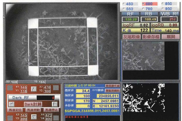
圖三 多光譜影像擷取系統整合控制介面
