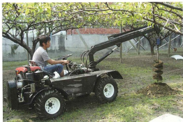
圖三 鑽孔機構在車體前方，操作方便，鑽完孔帶出部分土壤
