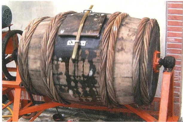
圖二 青梅與粗鹽混合於木桶中攪拌以去除表皮細毛
