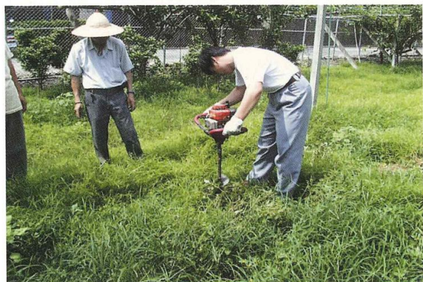
圖二 人力手持小型引擎動力鑽土機械鑽孔
