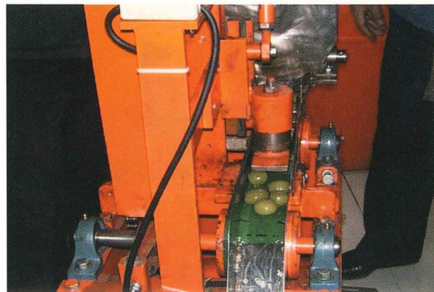
圖四 脆梅壓裂機之壓裂作業情形
