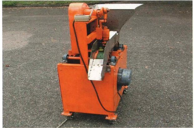
圖六 脆梅壓裂機外觀
