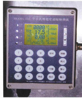
圖四 線上導電度檢測儀顯示螢幕及面板
