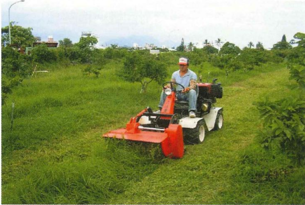
圖八 四輪傳動割草機延伸產品鏈刀式割草機果園割草作業
