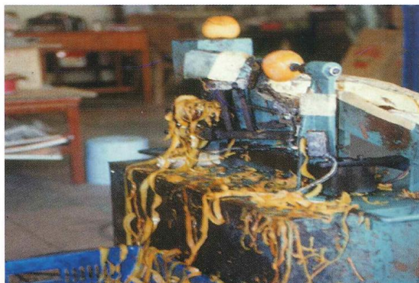
圖一 傳統柿子加工削皮機作業情形
