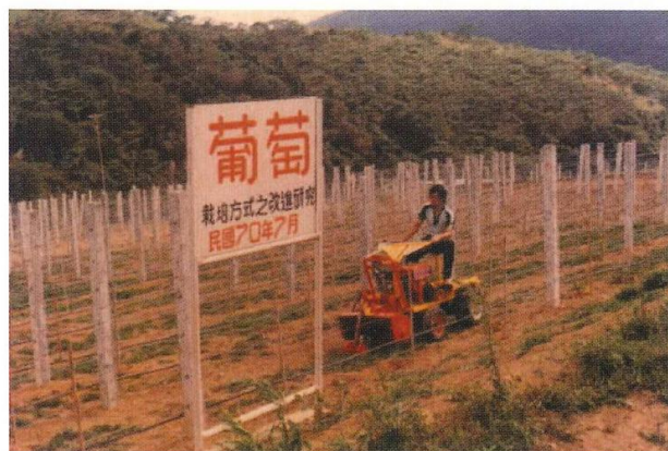
圖一 第一代坡地多用途作業機葡萄園割草作業
