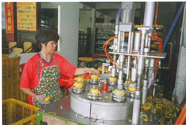
圖五 柿子加工削梗修蒂與削皮機進料定位作業情形
