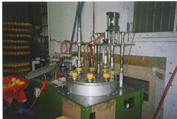
圖六 柿子削梗、修蒂、果肩果頂削皮及吸附上昇等一貫化作業情形
