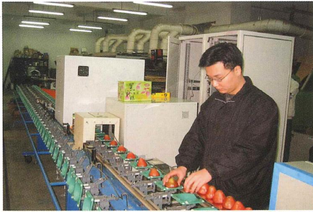
圖一 水果品質非破壞性線上檢測系統全貌
