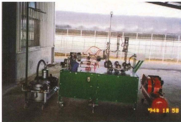
圖三 柿子加工削梗修蒂與削皮機
