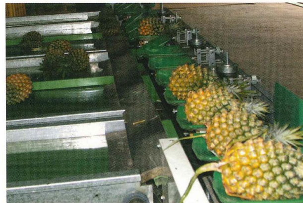
圖五 以天平秤差感應傾倒承果盤
