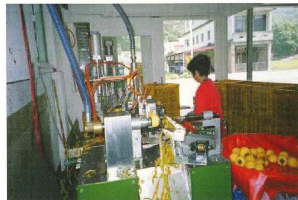
圖八 橫向吸附固定削皮作業情形
