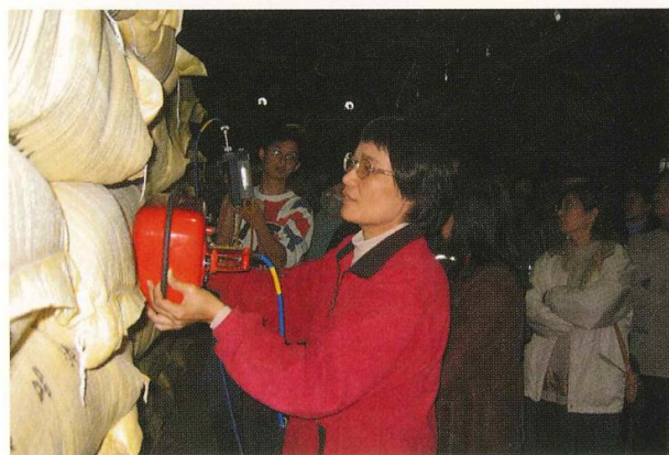
透地雷達施測現場
