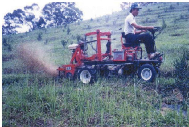
圖二 第二代坡地多用途作業機坡地柑桔園割草作業
