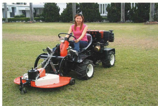
圖五 16ps 柴油引擎四輪傳動四輪轉向之四輪傳動割草機
