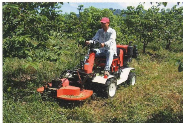
圖四 16ps 柴油引擎二輪傳動四輪轉向之乘坐式割草機
