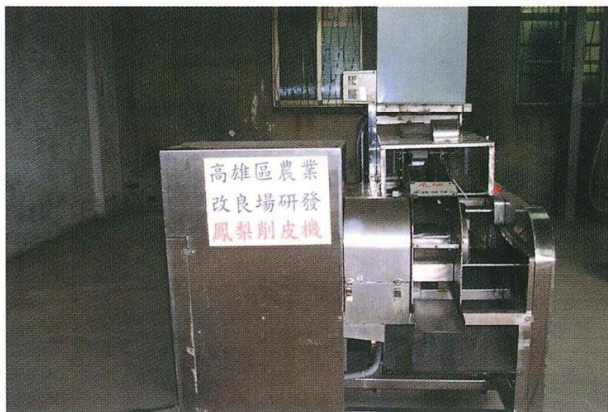
圖二 鳳梨削皮兼抽硬果心機正視
