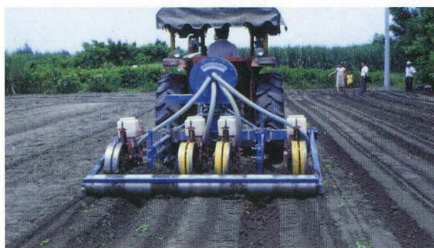
圖二 曳引機承載花生作畦真空式播種機
