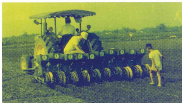
圖一 曳引機承載皮帶式花生播種機
