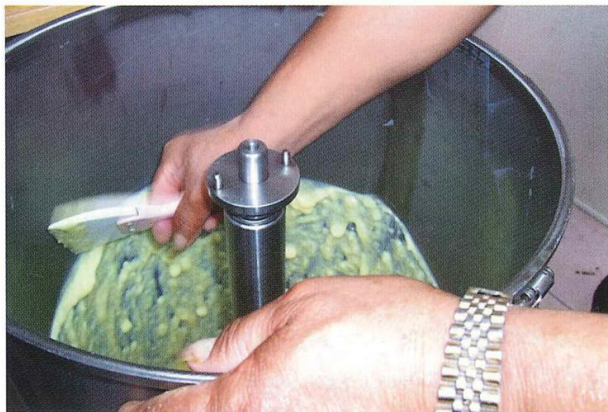
圖七 利用刮漿板刮漿
